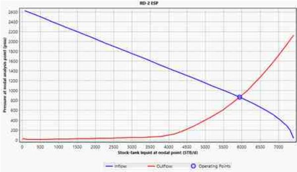
**Gambar 6.** Kurva IPR vs VLP Untuk Sumur Dengan ESP.
